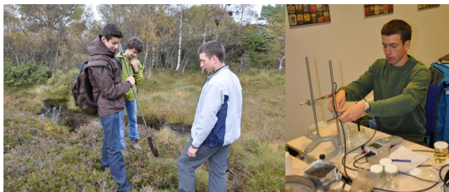
Abb. 1: Entnahme einer Bodenprobe (links) und Messung des pH-Werts und der Leitfähigkeit (rechts).
