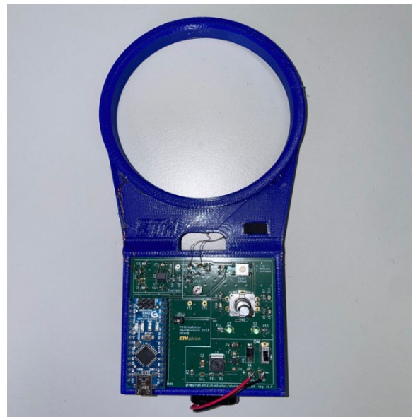
Aufbau eines Metalldetektors mit Platine und Suchspule.
