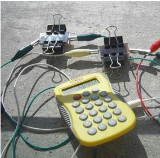
Mit den selbstgebauten Solarzellen kann man bei schönem Wetter sogar einen einfachen Taschenrechner betreiben.
