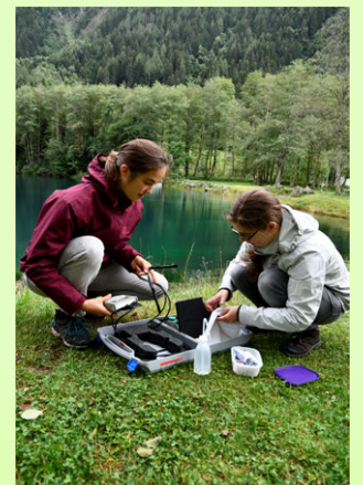
Abb. 4: Arbeit im Feld beim Messen des pH-Werts und der elektrischen Leitfähigkeit.
