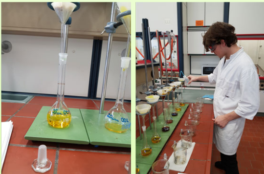
Abb. 2: Filtration nach dem Königswasser-Aufschluss der Bodenproben.
