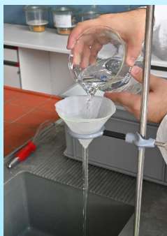
Abb. 3 (links): Filtration der Blindproben im Labor. In diesem Fall wurde Leitungswasser ohne Salz in einer Rakokiste (im Hintergrund) angerührt und danach filtriert.
