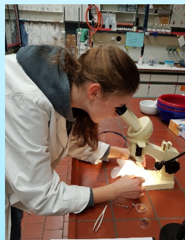
Abb. 3 (links): Filtration der Blindproben im Labor. In diesem Fall wurde Leitungswasser ohne Salz in einer Rakokiste (im Hintergrund) angerührt und danach filtriert.
