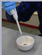
Abb. 6: Zur gemörserten Ameise werden in diesem Schritt Puffer hinzugegeben, welche die DNA freilegen.
