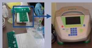
Abb. 7: Primer und Polymerasen werden zu den Proben gegeben (links). Anschliessend werden die Proben in das PCR-Gerät (rechts) gegeben, um die DNA in den Proben zu vervielfältigen.
