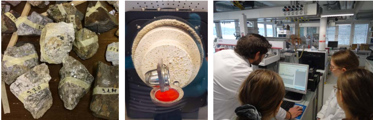
Abb. 14: Um Gesteinsproben (links) zu einer Fluxpille zu verarbeiten (Mitte), braucht es professionelle Apparaturen, die wir im Institut für Geochemie und Petrologie der ETH Zürich nutzen durften. An der Zürcher Hochschule für Angewandte Wissenschaften ZHAW in Wädenswil konnte die Projektgruppe Pilze ihre Proben am Gaschromatographen mit gekoppelter Massenspektrometrie (GC-MS) vermessen (rechts).
