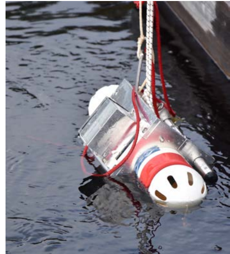
Abb. 5: Foto des Wasserprobennehmers, mit dem Wasserproben aus bis zu 100 m Tiefe genommen werden können.
