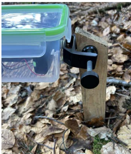
(a) Befestigung eines Blitzes.
