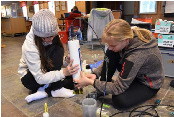
Abb. 4: Vor jedem Messtag mussten die Sensoren der Hydrolab-Wassersonde geeicht werden (links). Um Proben aus dem anstehenden Gestein zu gewinnen, musste teilweise zu Hammer und Meissel gegriffen werden (rechts).
