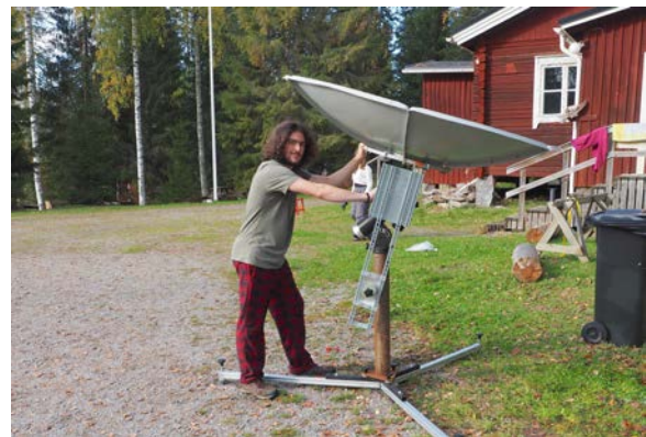
Abb. 8: Für das Teilprojekt «Radio Natur» musste das Atmosphärenphysik-Team die Apparaturen selbst zusammenlöten (links). Die 2 m-Schüssel des Radioteleskops ist zerlegbar und musste zunächst an einem günstigen Ort aufgebaut, zusammengesetzt und verkabelt werden (rechts).
