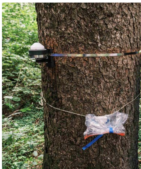
Abb. 5: An einem Nadelbaum installiertes Dendrometer (oben) und zusätzliche Messgeräte für Temperatur und Luftfeuchte, geschützt gegen Regen mit einer Eigenkonstruktion (unten).
