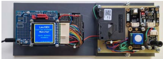
Abb. 2: Selbst zusammengestelltes Messgerät mit verschiedenen Sensoren und deren Messgrößen.
