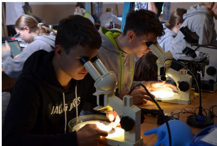
Abb. 4: Auszählen der Mikroplastikpartikel unter dem Binokular-Mikroskop mit VIS-Licht.
