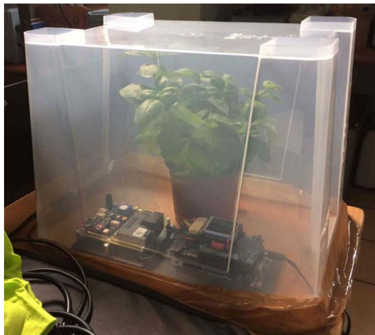
Abb. 3: Messkammer mit Sensoren und Testpflanze Basilikum.
