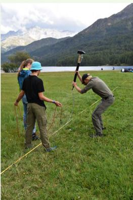
Das Geophon  $G_0$  wurde als Nullpunkt definiert. In Richtung Strasse wurde der Abstand positiv, in Richtung See negativ gemessen. Pro Schlagpunkt wurden fünf Schläge durchgeführt. Die Ankunftszeiten der Wellen wurden mit einem Python-Programm bestimmt und bei der Auswertung gemittelt. Die Mittelwerte wurden anschliessend in Laufzeitdiagrammen dargestellt.
