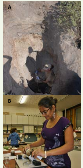
Abb. 2: Messung der Tiefe des Bodenprofils (A) und Aufschlammung der Proben zur Messung des pH-Werts, der Leitfähigkeit und der Ionenkonzentrationen mittels IC (B).
