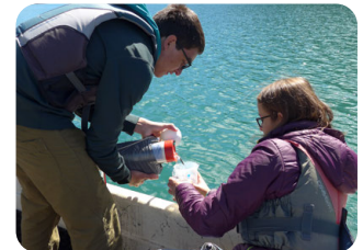
Abb. 3: Entnehmen von Wasserproben aus dem Wasserprobennehmer
