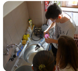
Abb. 2: Eichen der Hydrolab-Sonde
