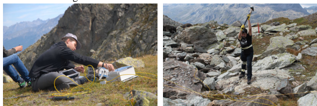
Abb. 4: Einstellen des Messverstärkers (rechts). Messung auf der Geröllhalde beim Corvatsch (links).
