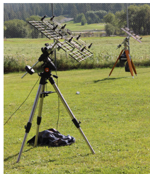
Abb. 1: Der Transit eines Flächenstrahlers hat zur Folge, dass die Signale sich nie ganz zu Null addieren. Aus diesem Grund sind die Interferenzminima um S_{\min} angehoben. Daraus kann der Winkeldurchmesser der Radioquelle berechnet werden.
